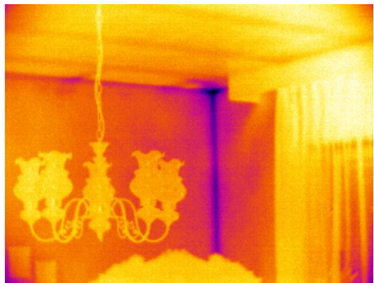
Abbildung 6: Luftundichtigkeiten Dach + Wärmebrücke Wandecken/Glasbausteine
